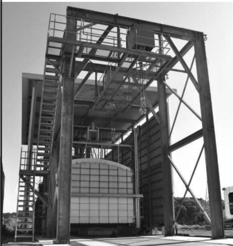
**炉内有効寸法** L9,000mm×W5,100mm×H2,800mm
